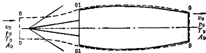
图 2-4 推导推力公式用图
