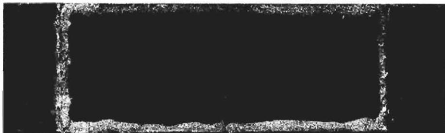
(b) 加速腐蚀7个周期,修理后再加速腐蚀6个周期的腐蚀情况(局部)
