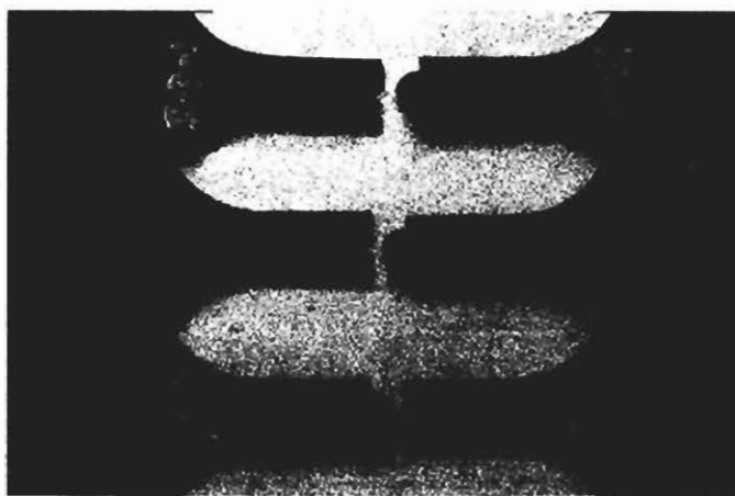
(c) 加速腐蚀 250h 后的疲劳试件 (背面)
