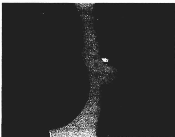
(c) 歼8Ⅱ后续飞机机轮半轴加速腐蚀 125h 后的疲劳试件 (局部)
