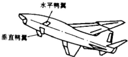
图 4.3.6 安装在机头部位的前置水平和垂直鸭翼
