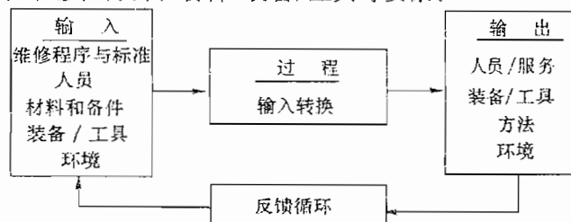
图 6-1 航空维修过程控制示意图
