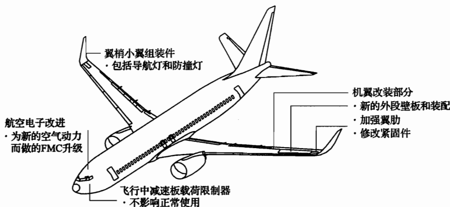
图 6-154 在已经使用中的波音 737-800 飞机上加装翼梢小翼后对飞机的改装
