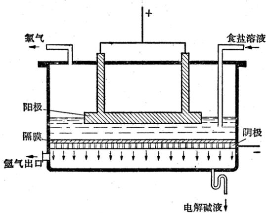
图 2·4 水平式隔膜电解槽示意图
