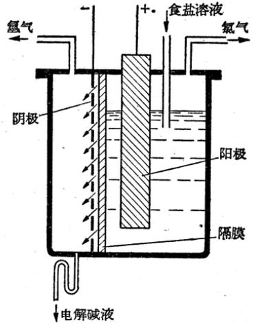
图 2·5 垂直式隔膜电解槽示意图
