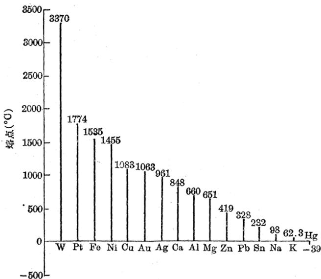
图 1.4 金属的熔点
