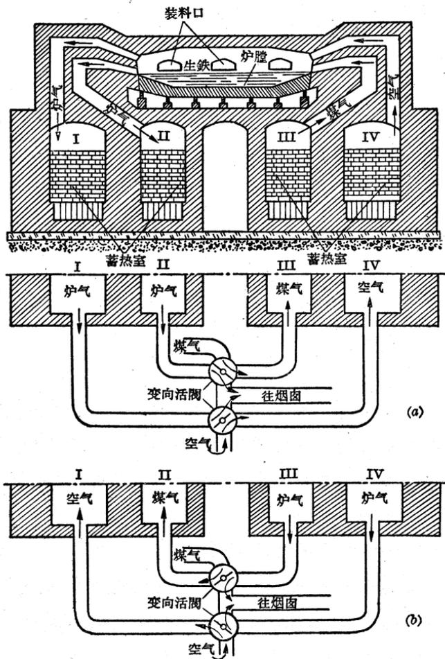
图 5·6 平炉示意图
