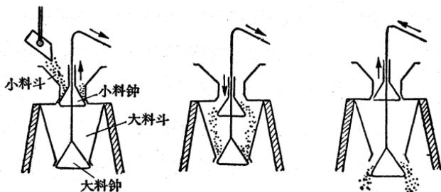
(a) 炉料进入小料斗 (b) 炉料进入大料斗 (c) 炉料进入炉内
