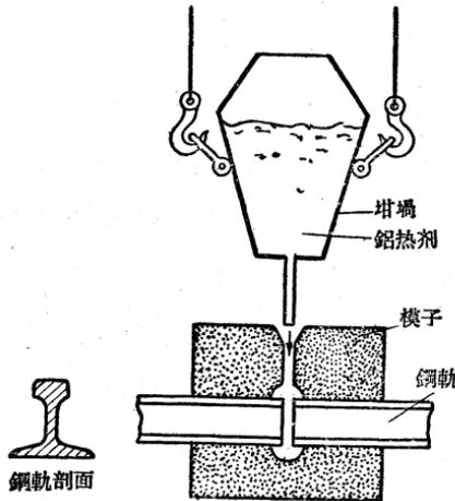
图 4.2 用鋁热剂焊接鋼軌 (剖面图)
