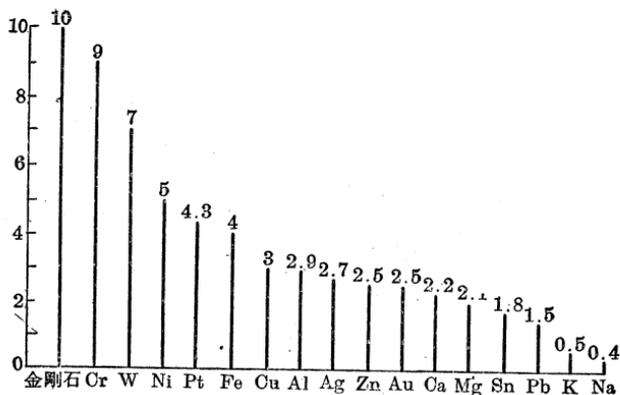
图 1-5 金屬的硬度和金剛石硬度的比較
