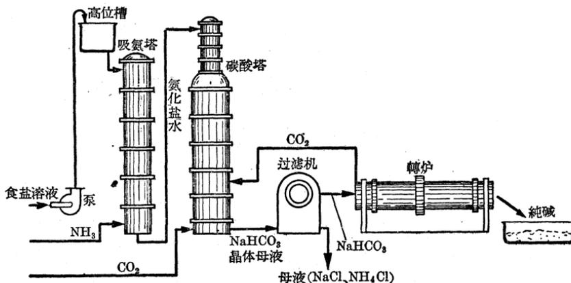
图 2·6 用氨碱法制造純碱的流程簡图
