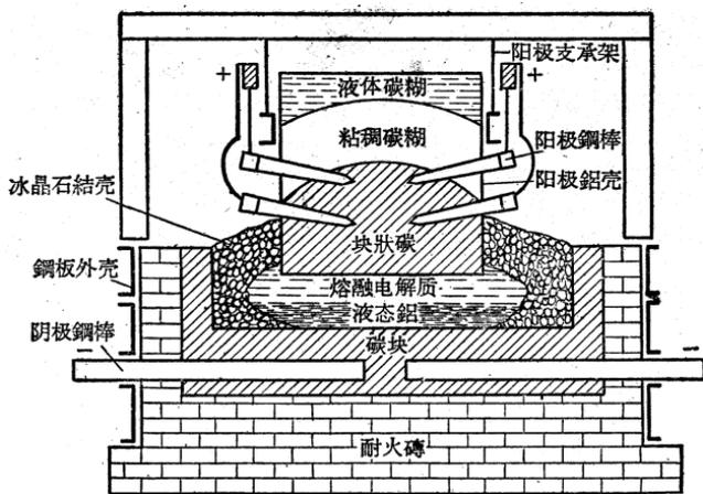
图 4·3 氧化铝的电解槽示意图
