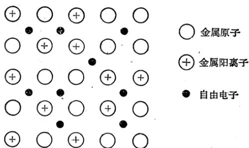
图 1.1 金属结构示意图
