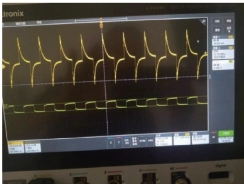
图 6.26 给真实的有机电致发光器件施加脉冲电压而得到的输出电压、电流曲线。图的下部为脉冲电压，上部为得到的脉冲电流。很明显，在脉冲电压的高电平期（5V），脉冲电流是正向的。在脉冲电压的低电平期（0V），器件仍有一个很强的反向脉冲电流。这正是抵抗电场存在的实验证据
