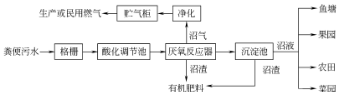
图 6-34 综合利用模式 A 工艺流程
