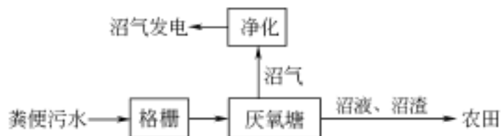
图 6-35 综合利用模式 B 工艺流程
