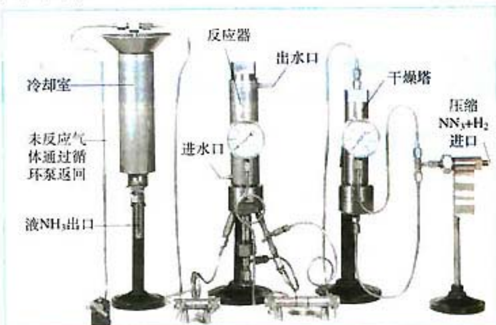
图1-6 哈伯合成氨实验用的装置
