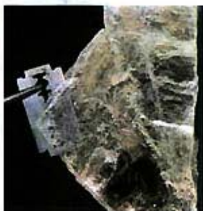
(b) 云母中 [\text{SiO}_4] 联结为平面层状结构
