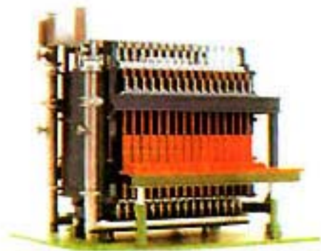
图 2-10 离子交换膜电解槽
