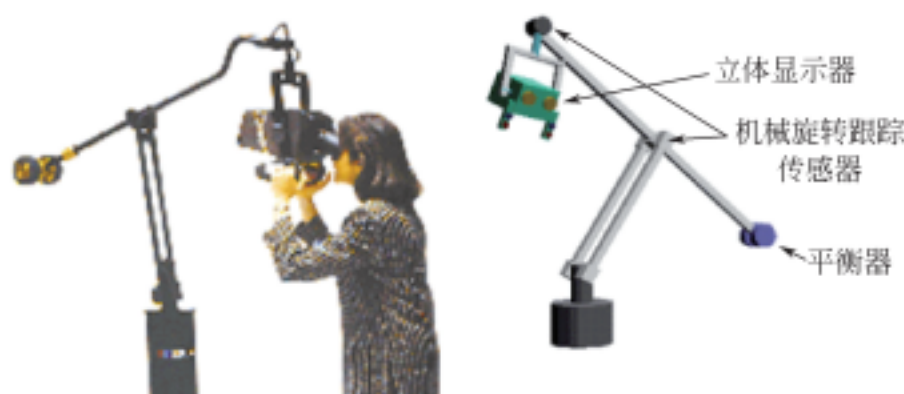
图 1.9 Fake Space BOOM 原理示意及效果图 [8]
