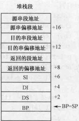
图 7-3 LT707 的堆栈区（大型模型）
