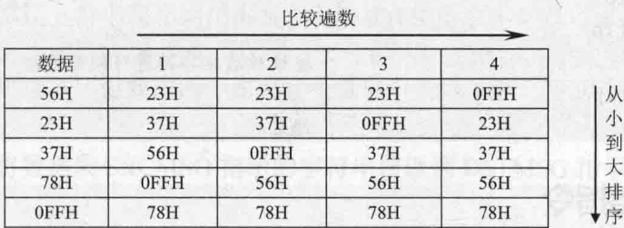
图 4-5 冒泡法的排序过程
