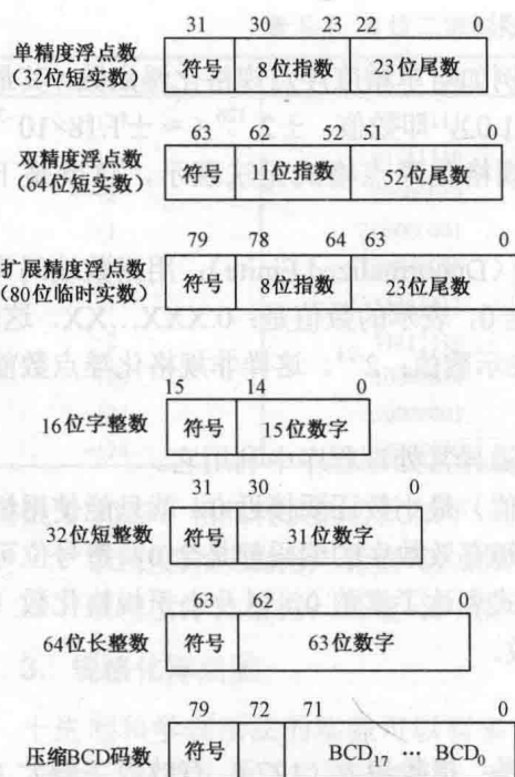
图 8-2 FPU 的数据类型以及各自表达的数据范围和精度
