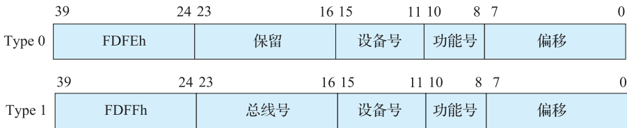
图 7.3 HyperTransport 总线配置访问的两种类型
