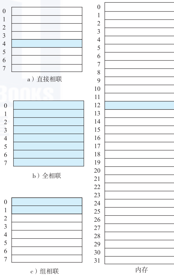
图 9.24 直接相联、全相联、组相联映射
