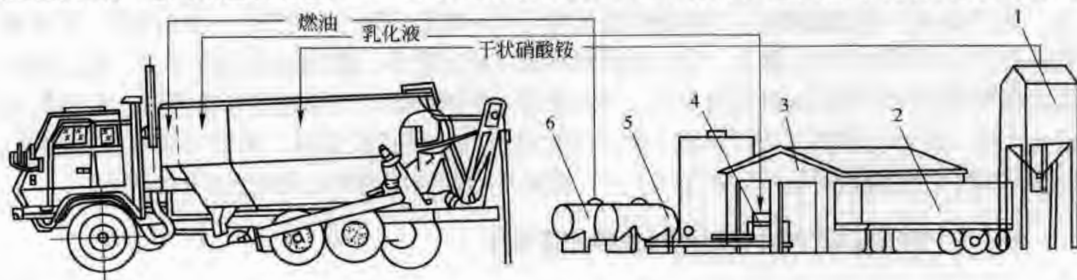
图 7-47 重铵油炸药在地面供应站上料示意图
