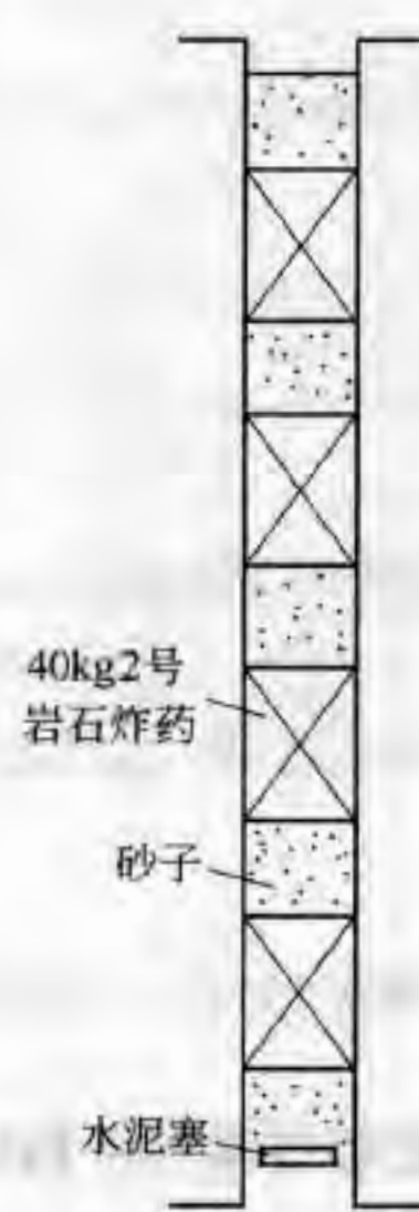
图 10-30 2 号岩石炸药间断柱状装药结构
