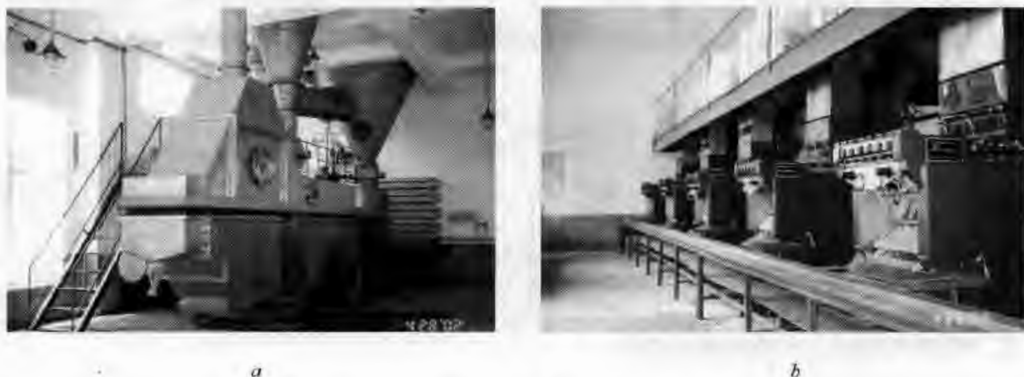
图 6-5 BGRIMM 粉状乳化炸药的主要生产设备实物图
