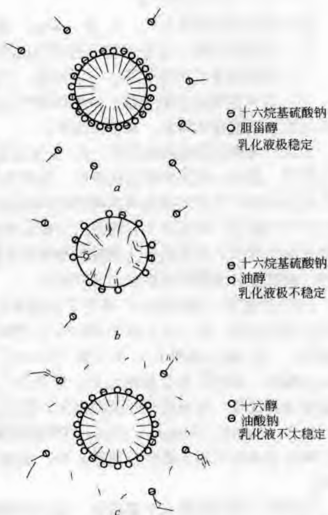
图 9-6 乳化液中油-水界面所形成的复合体系示意图
