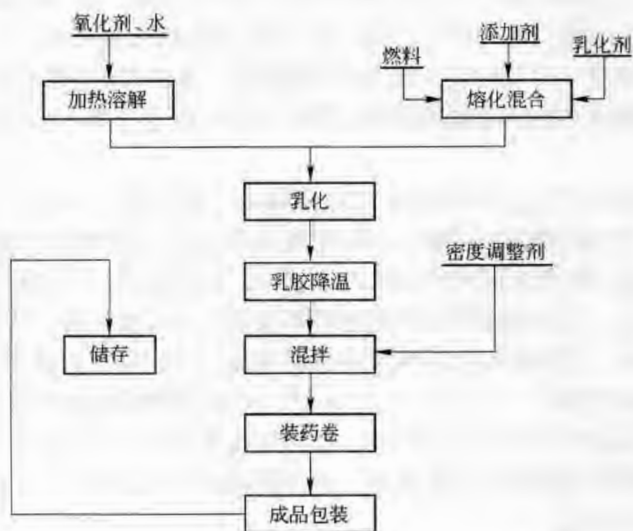
图 5-15 弹塑体乳化炸药的典型生产工艺流程
