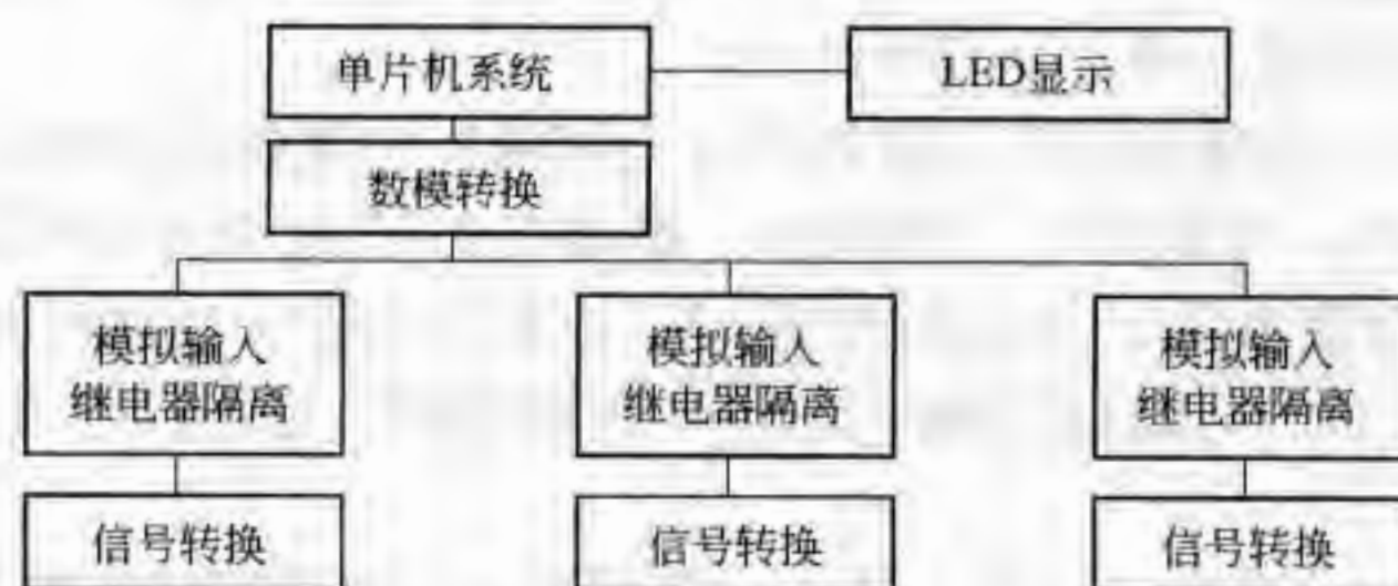
图 5-33 现场显示站工作原理图
