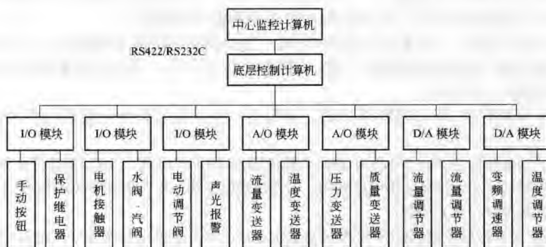
图 5-49 控制系统结构示意图
