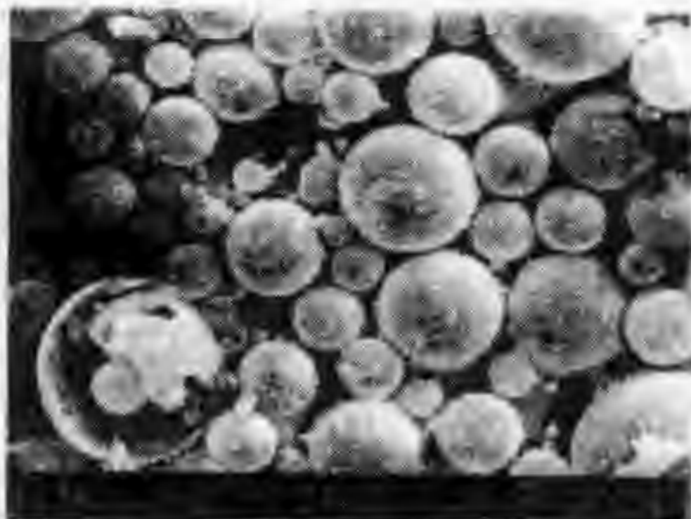
图 4-8 玻璃微球电镜扫描照片（放大 440 倍）
