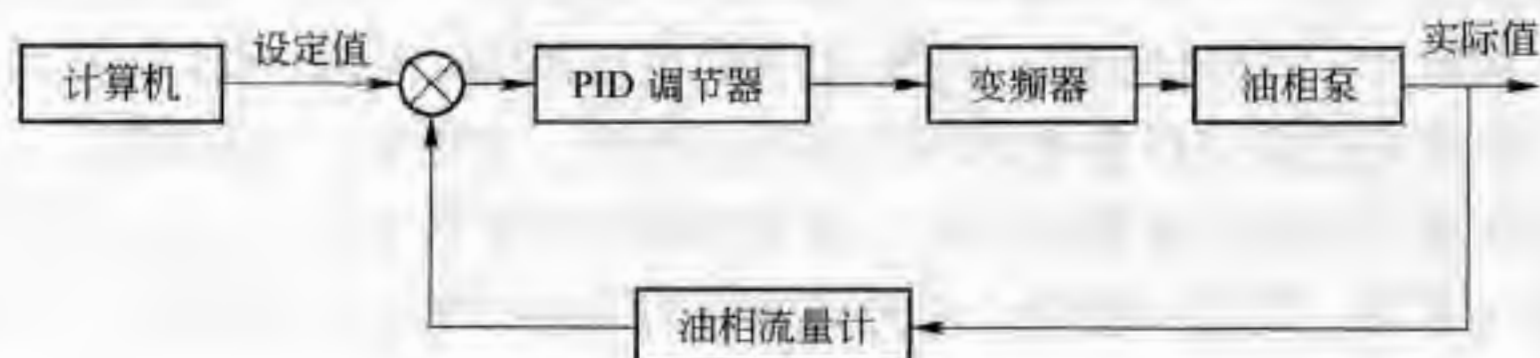
图 5-50 模拟 PID 调节原理图
