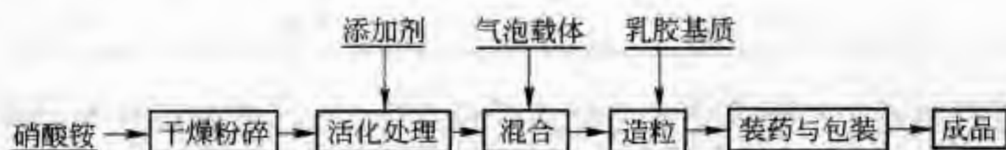
图 6-37 混药的主要工艺流程
