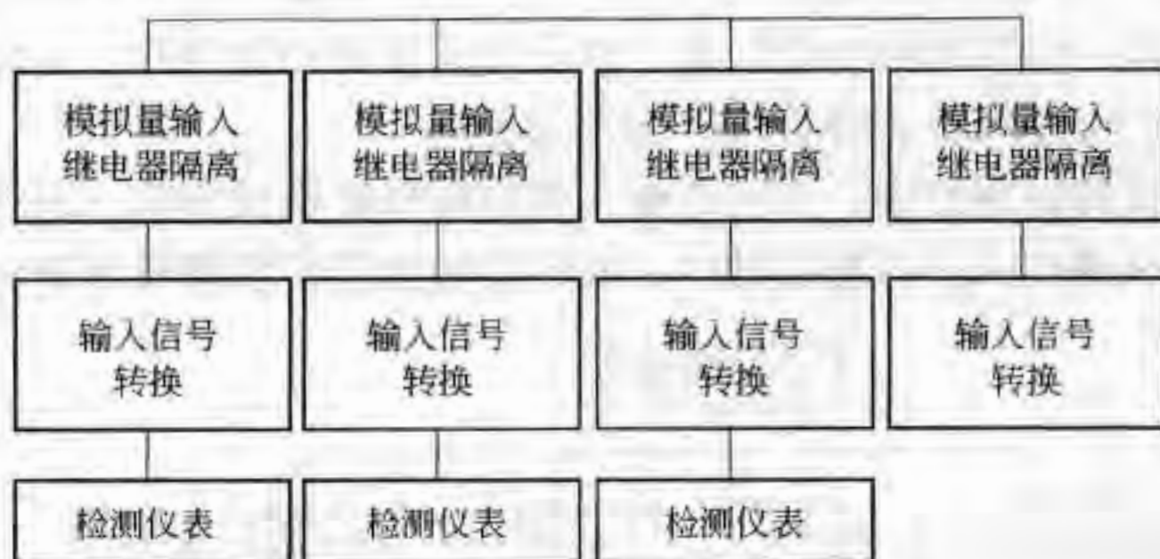
图 5-30 过程检测站的构成示意图
