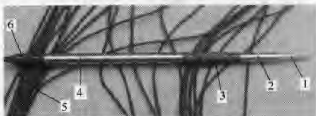
图 11-72 自由场压电压力计的外形结构图
