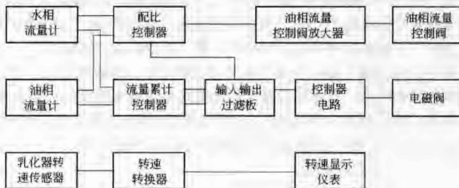
图 7-11 乳化炸药现场混装车自动控制系统原理图
