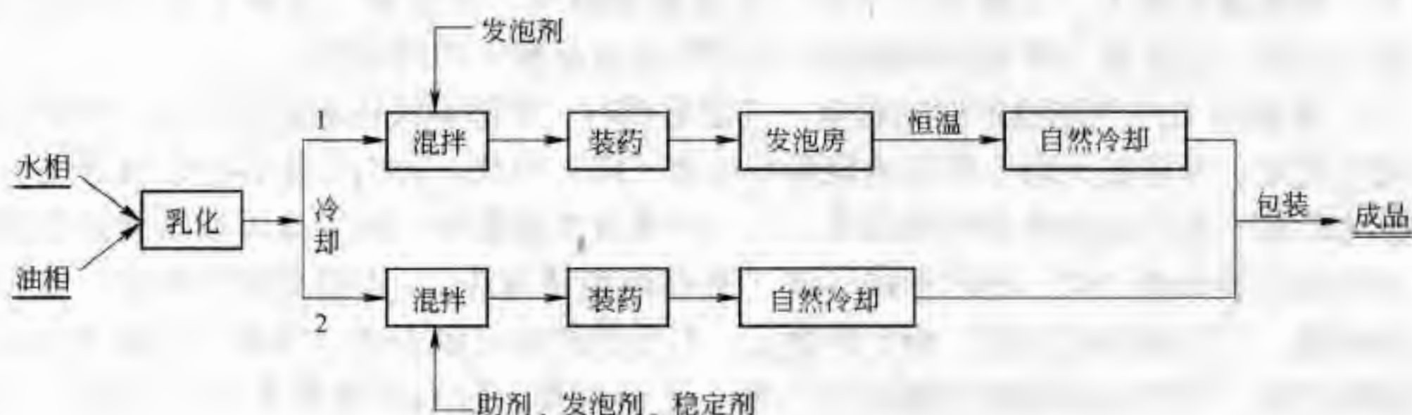
图 4-19 快速化学发泡与普通发泡工艺流程对比
