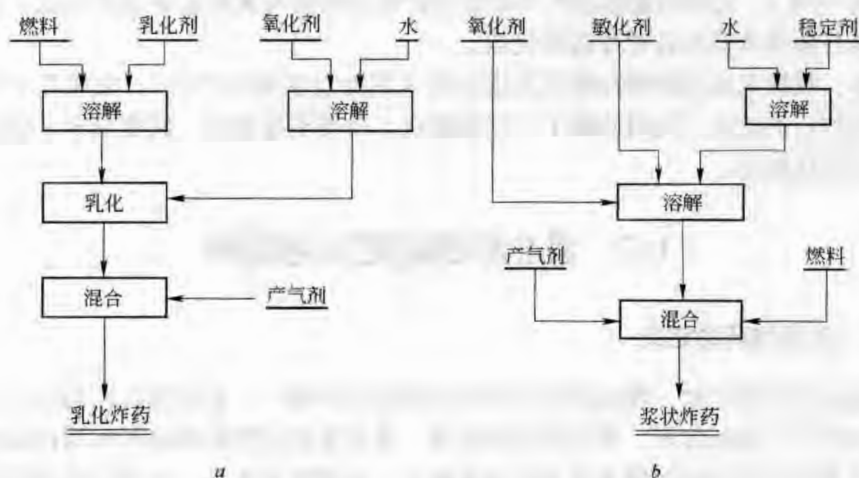
图 1-1 乳化炸药 (a) 和浆状炸药 (b) 生产工艺流程图
