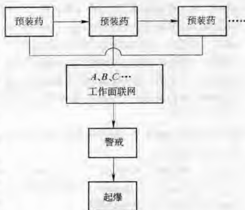
图 7-54 多工作面同时起爆系统图
