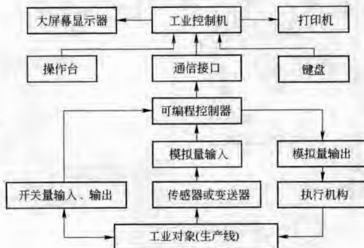
图 5-25 生产线自动控制系统构成方框图
