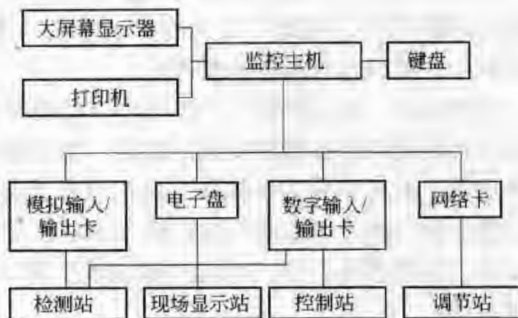
图 5-29 控制系统总体构成示意图
