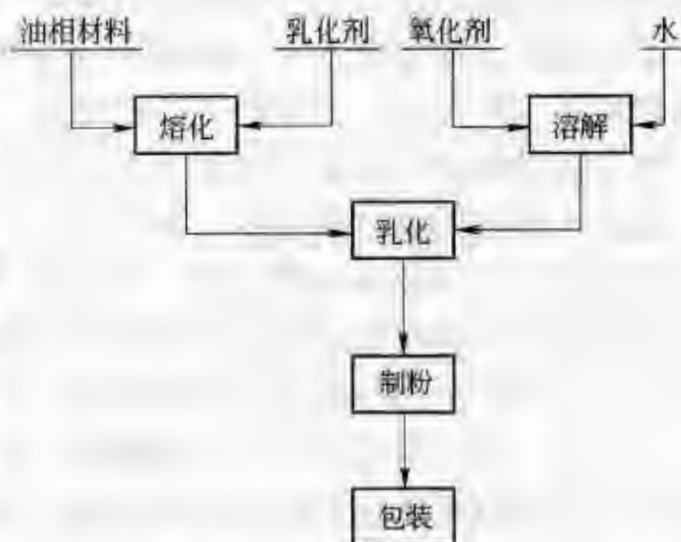
图 6-1 粉状乳化炸药的生产工艺流程框图
