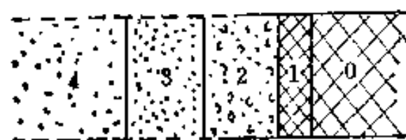
图6-11-2 难挥发炸药燃烧反应区
