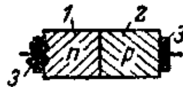
图2 面结合型二极管
