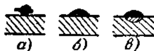
图3 用合金法制成 p-n 結的步驟 a ——熔化前; b ——最初熔化的鋼滴在鍺表面上; c ——在高溫下燒煉后
