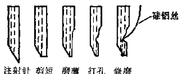
图 8-10 针焊法压刀的制作过程示意图
