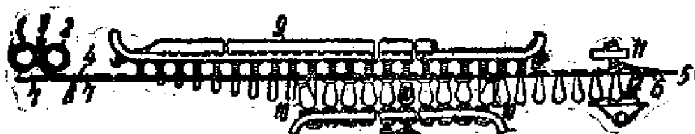
圖14-8 鏈式自动吹玻壳机。
