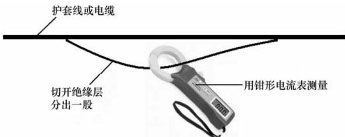
图 2-58 用钳形电流表测量护套线或电缆电流的方法
