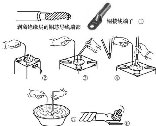
图 6-71 铜芯导线锡焊封端的方法
