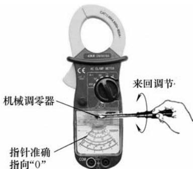
图 2-56 钳形电流表的调零
