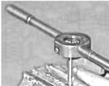
第③步, 切入 1~2 圈后检查垂直度
