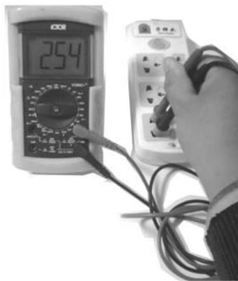
图 2-48 交流电压的测量
