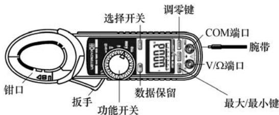
图 2-53 钳形电流表的基本结构
