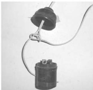
图 6-94 将电源线打一个电工结
