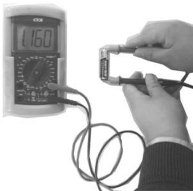
图 2-47 直流电压的测量
