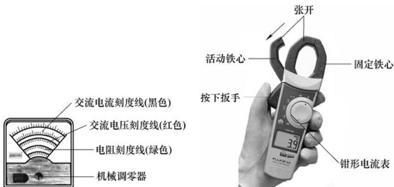
图 2-54 钳形电流表的表头结构
