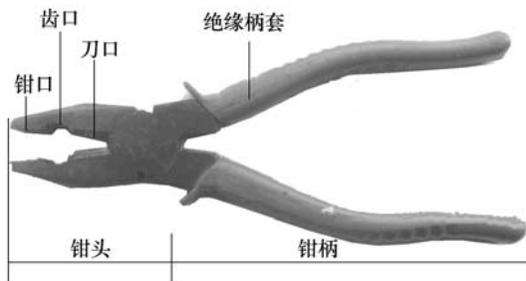
图 2-1 钢丝钳的结构图
