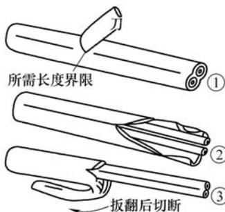
图 6-60 塑料护套线护套层的剥离
