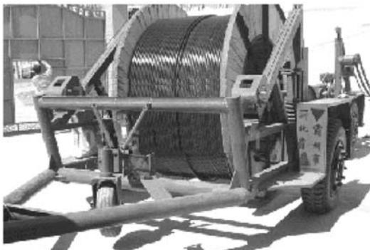
图 5-9 常用电缆放线架外形
