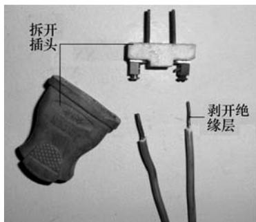
图 6-109 拆开插头、剥开绝缘层
