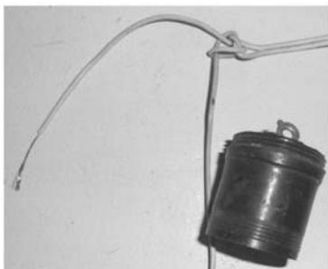
图 6-95 剥开线头绝缘并压接在接线柱上
