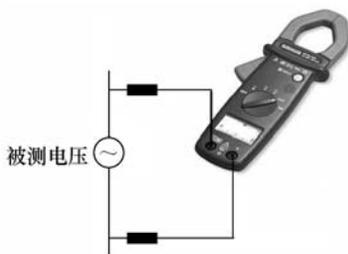
图 2-60 用钳形电流表测量交流电压的方法
