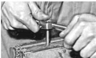
第②步, 开始套螺纹时一只手向下施加压力, 慢慢转动绞杠
