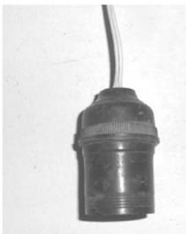
图 6-96 接线合格后，装上螺口灯头盖
