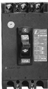
图 8-10 塑壳式空气断路器
