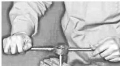
第⑤步, 匀速转动绞杠套出螺纹
