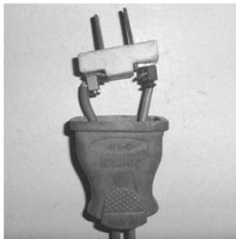
图 6-110 将导线正确地压在插头上
