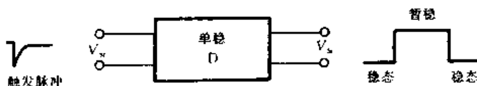
图 8-111 单稳态触发器的电路功能
