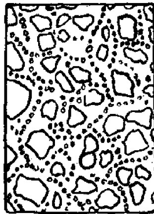
图9—316 具有惰性填料的合成物的结构图。黑色的点是导电体，白色的是填料。
