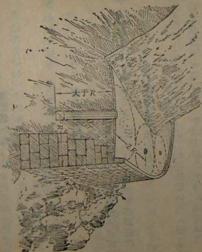
第46图 爆破山腹道挡土墙装药的配置
