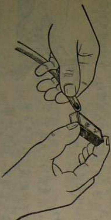
第30图 用火柴点燃点火管
