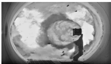
图3 高速摄像机拍下电磁炮弹丸发射瞬间
