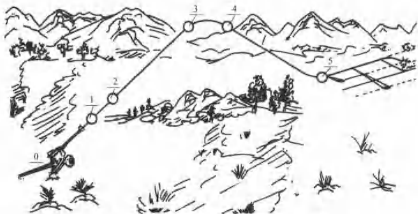
图 11.11 主动式末制导炮弹工作程序及弹道示意图
