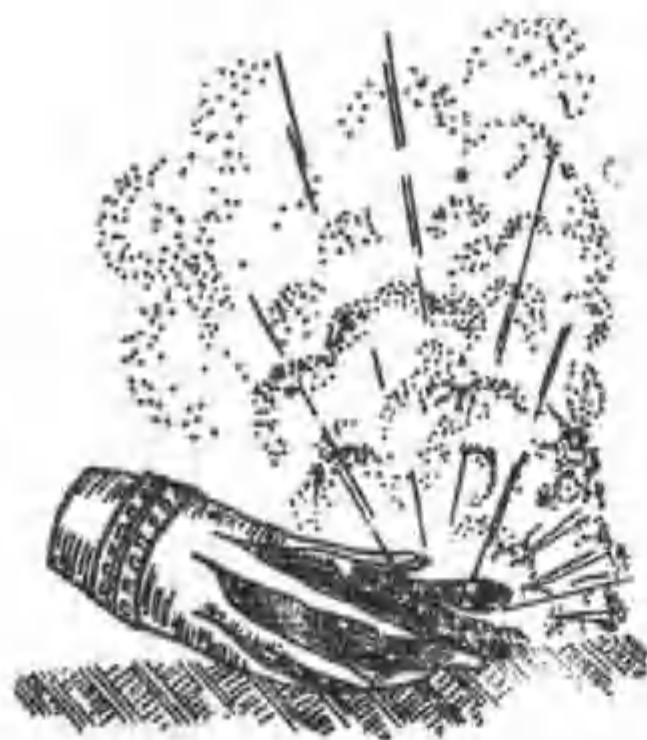
图 8.2 着发式烟幕弹的作用情况
