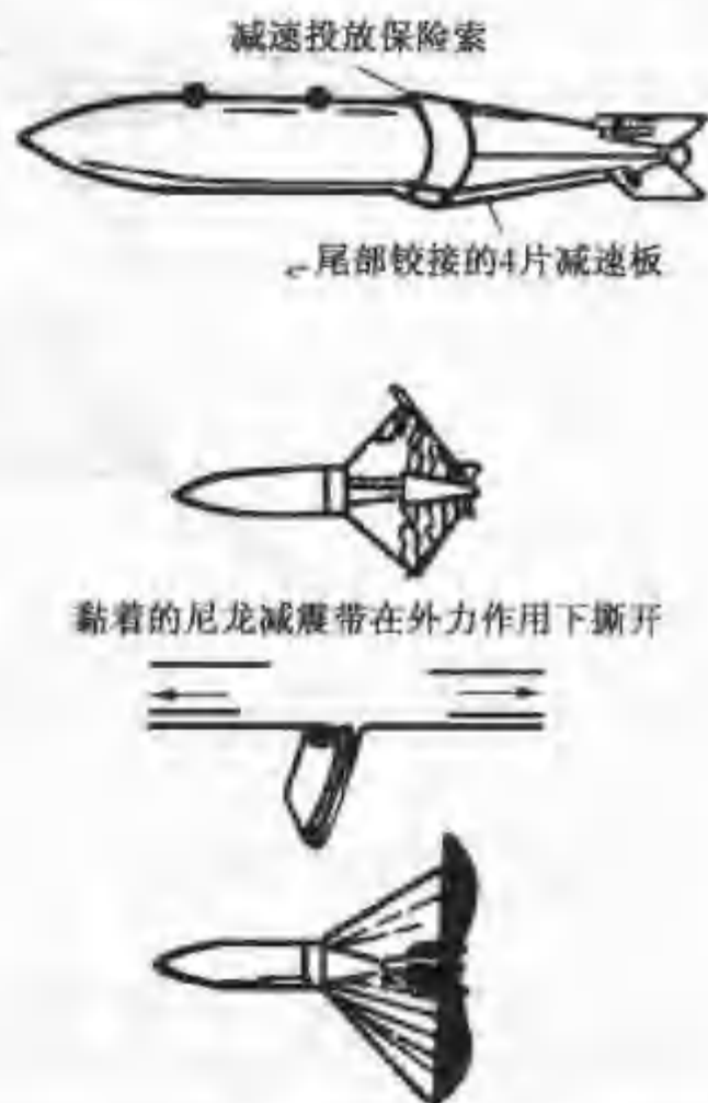
图 15.7 板伞复合式减速尾翼工作过程图
