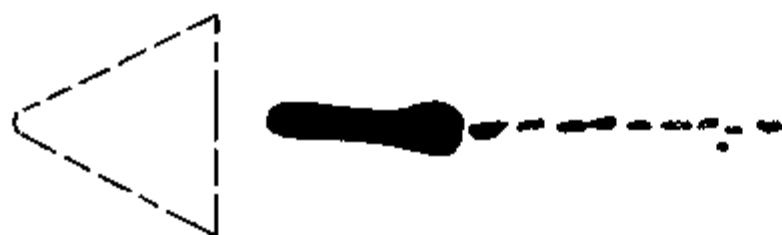
图 5.5 金属射流被拉断情形
