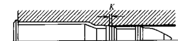
图 2.18 底缘定位的整装式药筒
