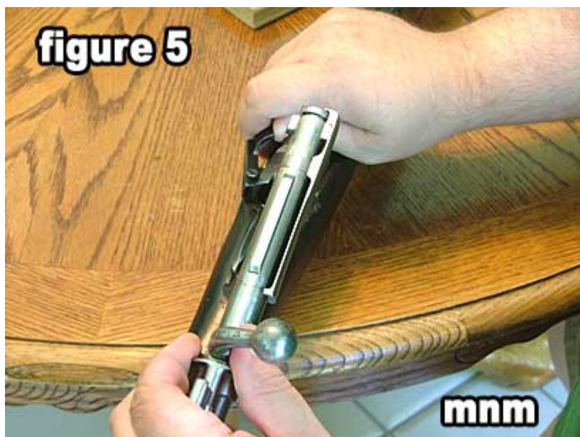
5) 接收端摆动左释放杆螺栓和螺栓取出。
