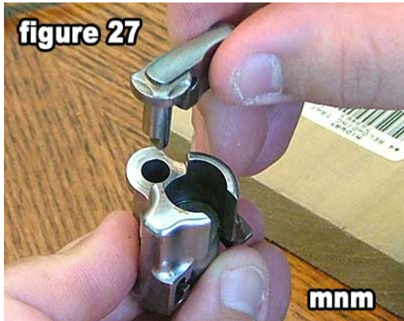
27) 插入螺栓套筒后方安全作为进入如图 27 所示。
