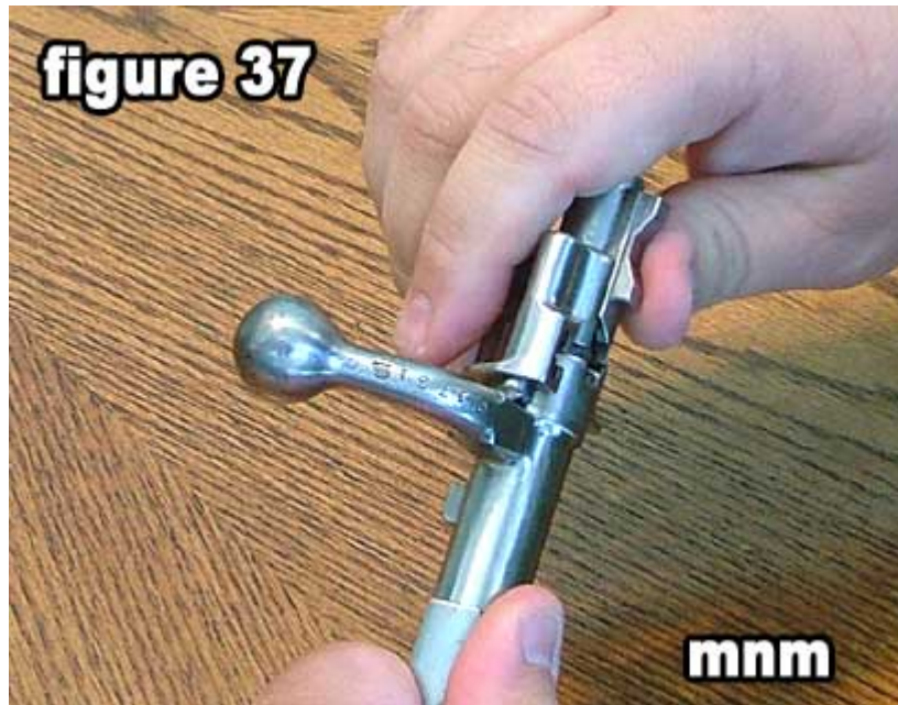
37) 顺时针旋转螺栓套筒。
