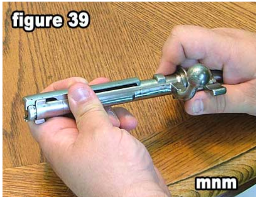
39) 旋转的提取将直接通过正确的耳栓手，如图 39 所示。
