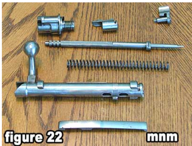
22) 图 22 显示了完整的毛瑟螺栓拆卸。
