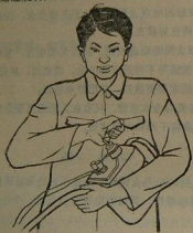
第36图 25发点火机使用方法
