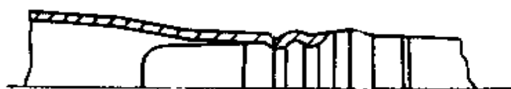
图11-1-3 药筒与弹丸间的滚沟结合
