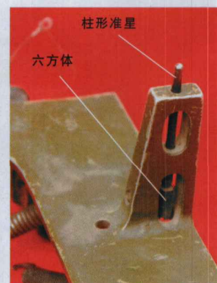
4-3 柱形准星 调整准星下部的六方体,准星的高度可升降
