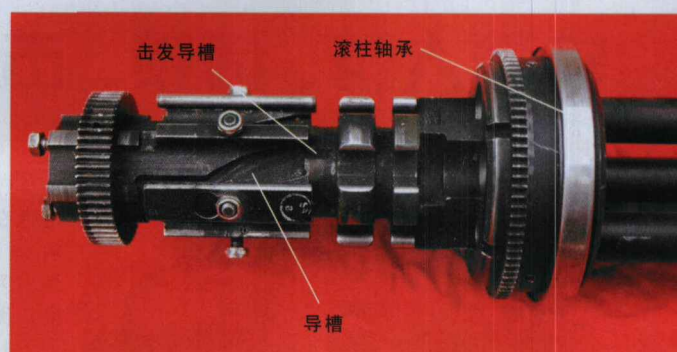
1-2 旋转体特写 旋转体前部装有滚柱轴承,与机匣装配在一起;中部有6个容纳枪机的导槽;导槽中有容纳击针尾部突起的击发导槽
