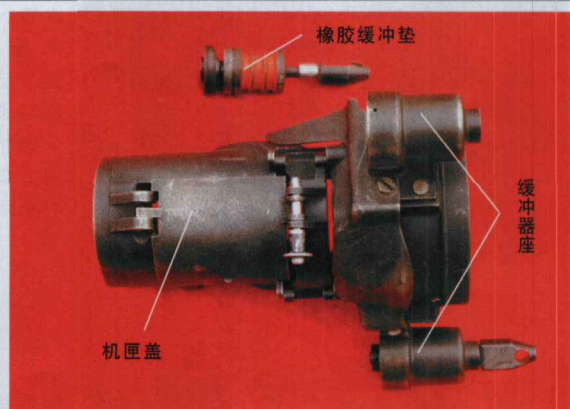
3-2 机匣组件分解之二 取出缓冲器内部的橡胶缓冲垫。枪身后坐时,缓冲垫被压缩,吸收后坐能量,该零件对减小后坐力起到很大作用
