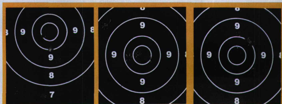
从左至右：SVD 狙击步枪、德国 TRG 狙击步枪、SV98 狙击步枪在同等射击条件下对 200m 处胸环靶射击结果对比
