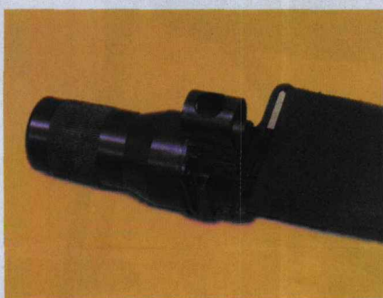
防反光带的前端扣在准星座上专门的孔里，带子不能翻转
