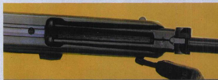
两脚架可以折叠收入护木下方的槽内
