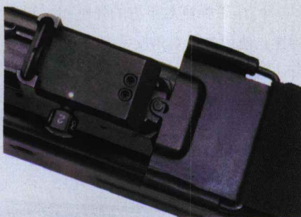
防反光带的尾端挂在导轨前端
