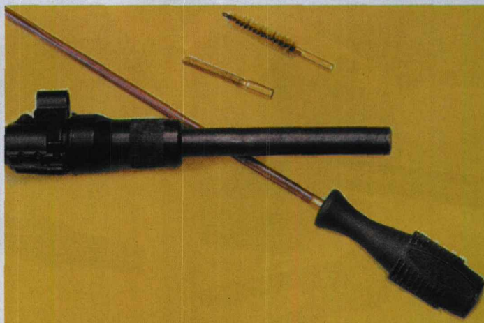
在清理枪管内膛时不仅需要用到通条、毛刷和铰刀等工具，还必须在膛口插入塑料保护套，以避免枪管口部膛线在保养时受到损伤
