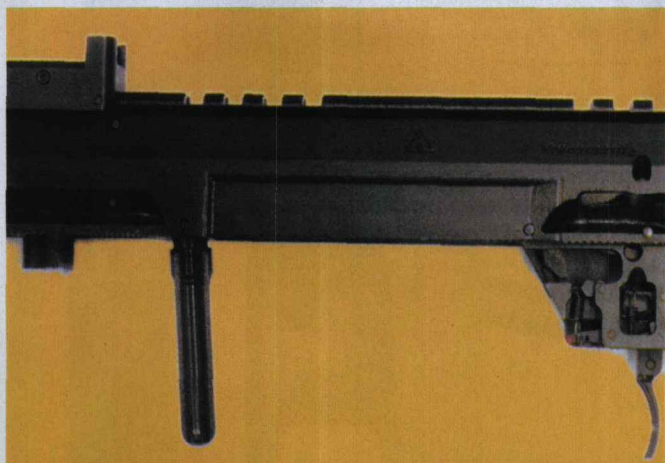
卸下护木和弹匣后，发射机构的结构清晰明了
